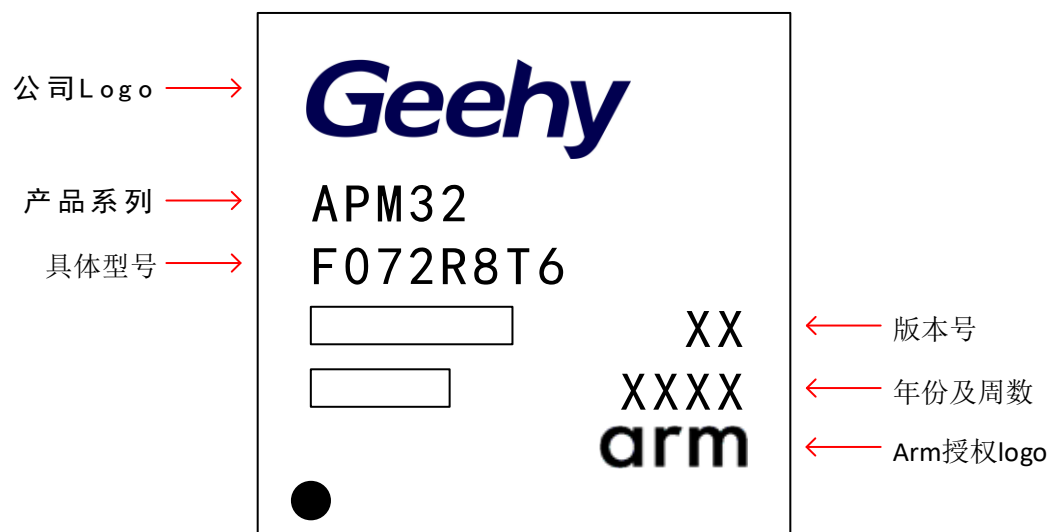
图 21 LQFP64 - 64 引脚，10 x 10mm 封装标识
