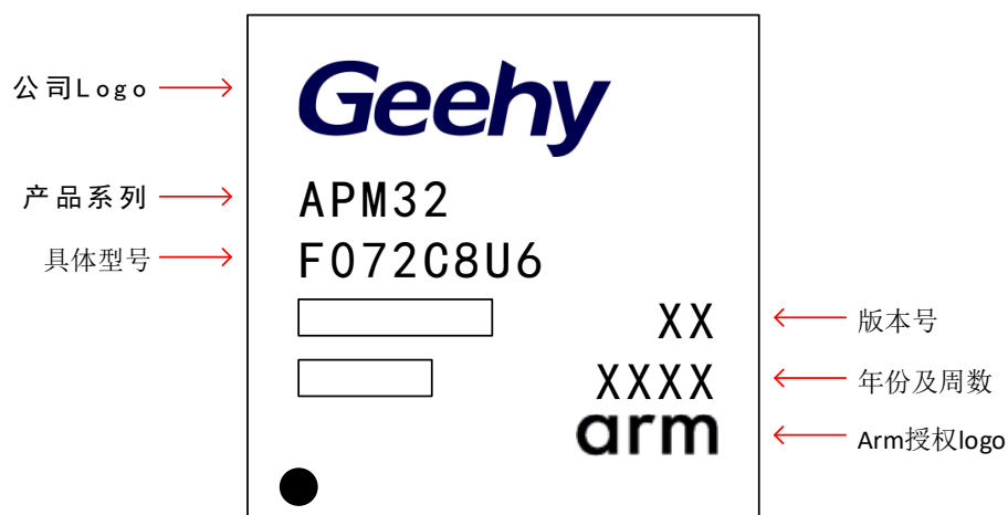
图 27 QFN48 打码规范
