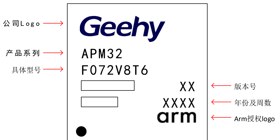
图 18 LQFP100 - 100 引脚, 14 x 14mm 封装标识
