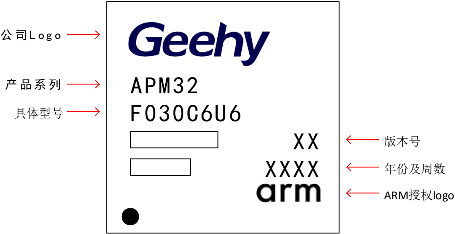
图30 QFN48 打码规范
